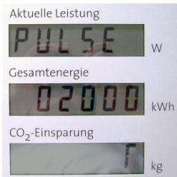
Die Einstellung der Impulse/kWh erfolgt analog zum Startwert. Die Einstellung der Impulse muss abgeschlossen werden, damit der Wert gespeichert wird.
