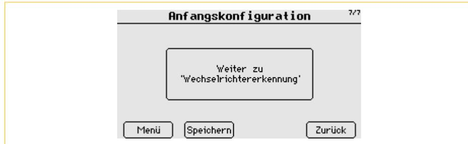
Da die Anfangskonfiguration eine schnelle Führung zu einem lauffähigen System sein soll, kann hier der Dialog „Wechselrichtererkennung“ (↗ unten) direkt aufgerufen werden.
