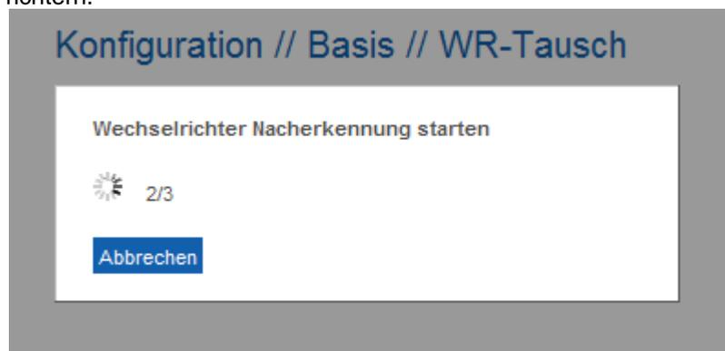
Die Suche kann einige Zeit dauern, in dieser Zeit erscheint obige Anzeige. Der Suntrol Datenlogger vergleicht die neu gefundenen Wechselrichter mit der Liste der bisherigen Wechselrichter.
