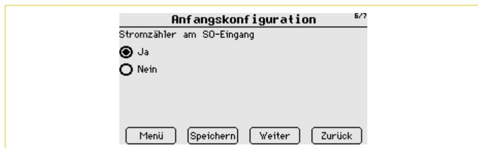
Hier wird, falls vorhanden, ein an den S0-Eingang angeschlossener Stromzähler aktiviert oder, falls nicht vorhanden, ausgeschlossen.
