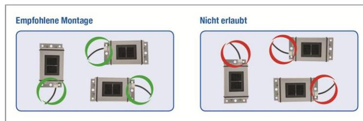
Bitte achten Sie bei der Montage des Sensors darauf, das Anschlusskabel entsprechend der Zeichnung anzuordnen.
